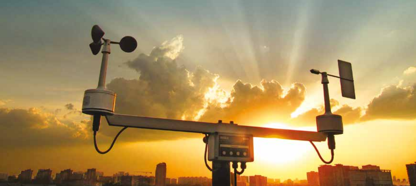
Электронный ветроизмеритель на 26-метровой вышке обсерватории
