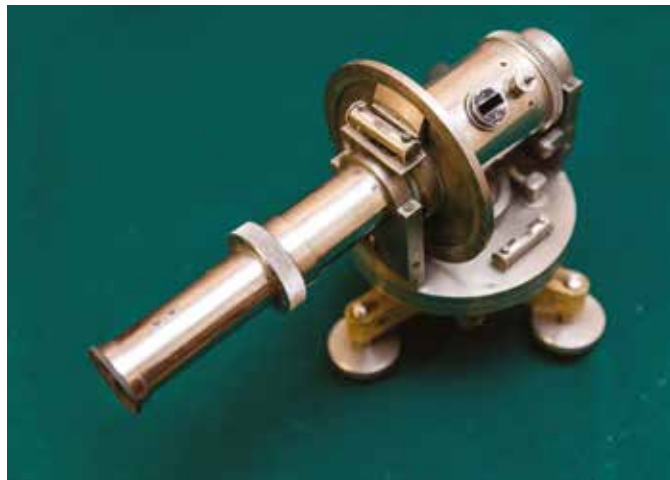
Актинометр — прибор для измерения количества солнечной радиации, поступающей на Землю
